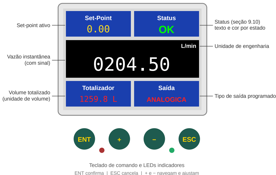
Figura 8 — Tela principal, teclado de comando e LEDs indicadores (valores ilustrativos)
